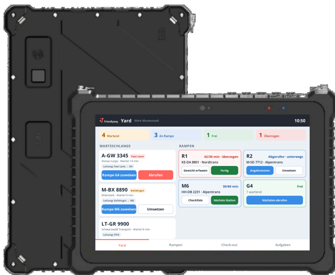
Abb. 11 · Rugged Tablet 10" mit Hof-Ansicht für den mobilen Einsatz: Warteschlange mit Leit-Hinweis, Rampen mit großen Aktionsknöpfen. (Beispielhafte Darstellung)
