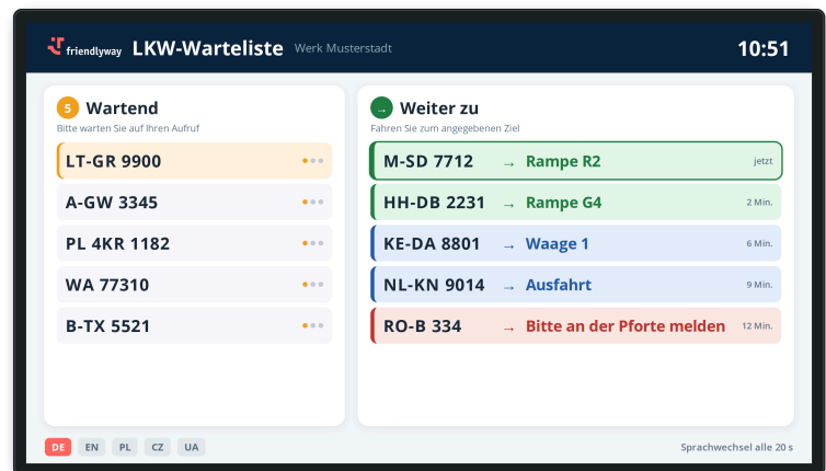
Abb. 10 · LKW-Warteliste: wartende LKW links, abgerufene LKW mit ihrem Ziel rechts – die Sprachen wechseln automatisch. (Beispielhafte Darstellung)
